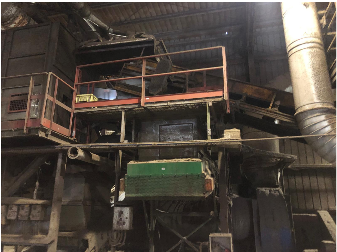
Impianto in esercizio (vaglio rotante)
